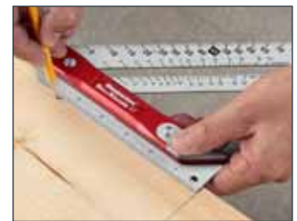
Version XT für Parallelanrisse
