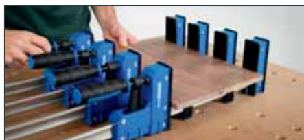
Verleimhilfen beim flächigen Verleimen von Massivholz
