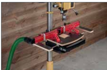
Saubere Sache, integrierter Absaugkanal im Bohranschlag
