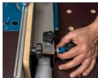
Exakt eingestellt mit den sauter Feineinstellern
