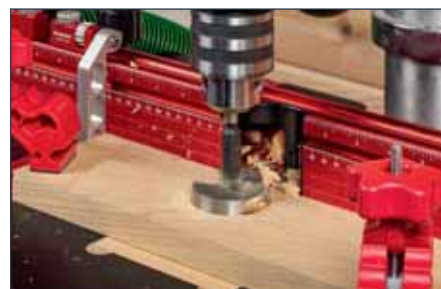
Präzise einstellbar für wiederholgenaue Bohrungen. Kontrastreiche Skalierung.
