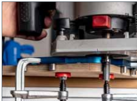
Clevere Nuten für Führungsschienezwingen, die ein stabiles Fräsen um die Kante garantieren.
