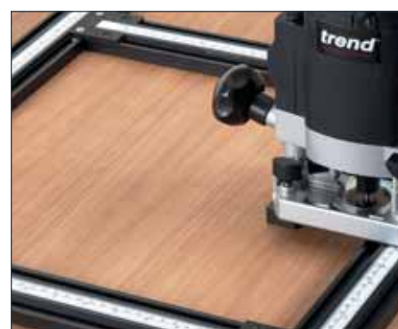
Dekorative Fräsungen mit Profilfräser und Varijig.
