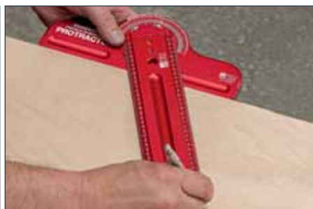
Aus dem WWR Lineal wird im Handumdrehen ein T-Square mit Winkelfunktion
