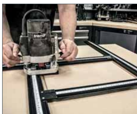
Sicher durch den mitgelieferten Abkippschutz. Von 20 x 20 bis max. 600 x 600 mm rechtwinklig fräsen.
