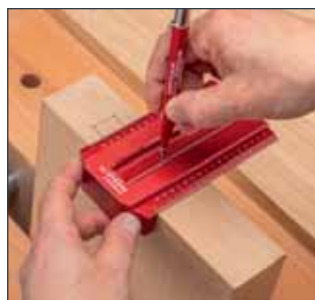
Stabiles und präzises Anreißern an der Kante
