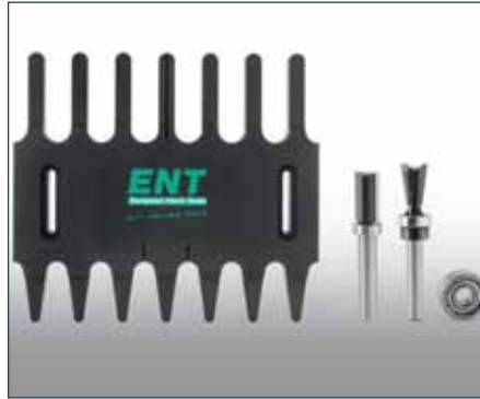
Metrische Schablone im Set mit Bündigfräser (Ø12 mm) und Zinkenfräser (Ø16 mm, 8°)
