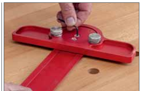
Einfach mit 2 Schrauben fixiert
