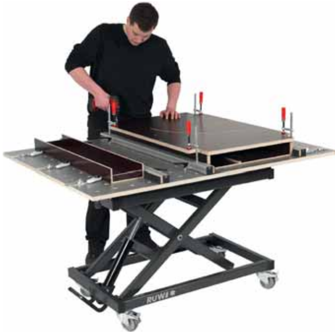
Lochrasterplatte aus stoß- und kratzfester HPL-Beschichtung.
