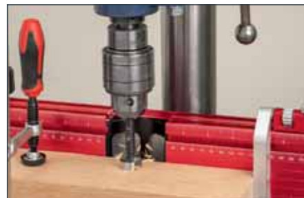
Anschlagreiter für wiederholgenaues Bohren (bei beiden Versionen im Lieferumfang)
