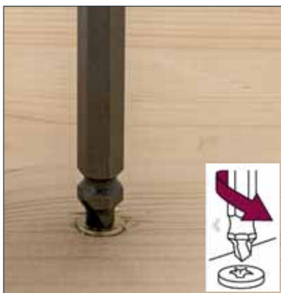
Beschädigten Schraubenkopf ausschälen (Linkslauf)
