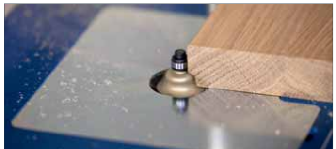
Hebel auf, Fräser rein/raus, Hebel zu
