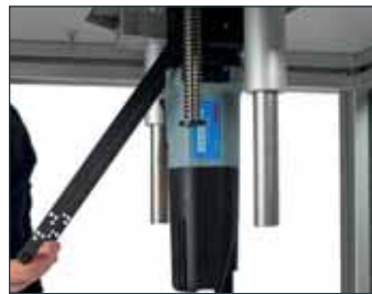
Hebel auf, Fräser rein/raus, Hebel zu
