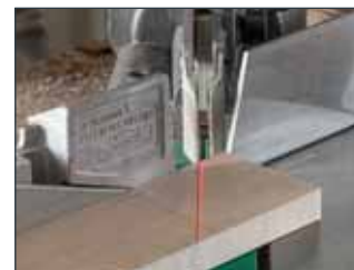
Der Engle Angle Mini holt sich den Winkel an engen Stellen
