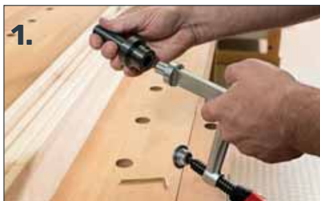
Adapter für alle Spanner Ø16 mm
