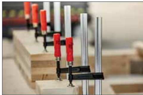
Temperguss-Schraubknecht TKPN mit bewährtem Holzgriff.
