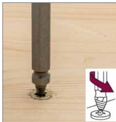
Gewinde in Schraubenkopf drehen (Linkslauf)
