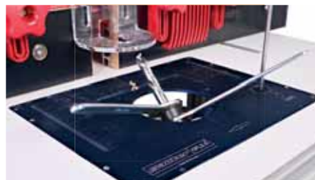
Bequemer Fräserwechsel von oben
