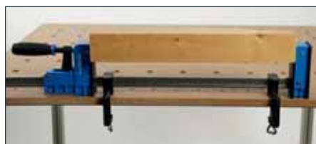
Verwendung als Spannbock an Werktaischen dank Spannmöglichkeit an den Abstandshaltern
