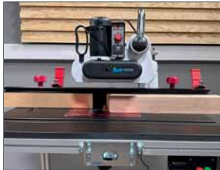
Der M3 Vorschubapparat passt mit dem Montage-Kit sehr gut an unsere sauter Frästische
