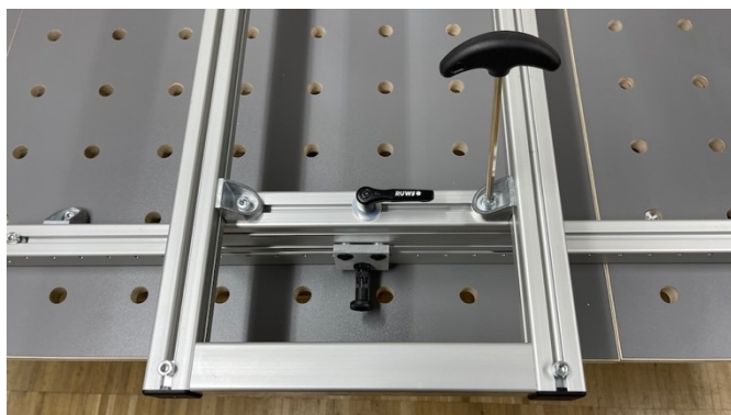
Abbildung 26: Querschienenrahmen mit den Längsträgern verbunden
