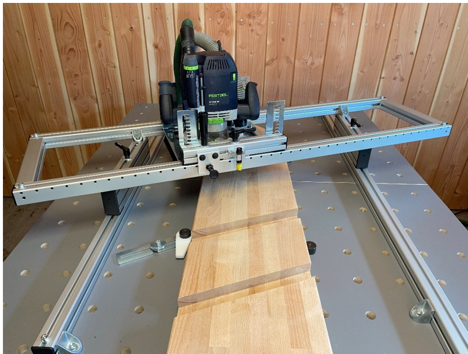
Abbildung 41: Bearbeiten von Treppenwangen
