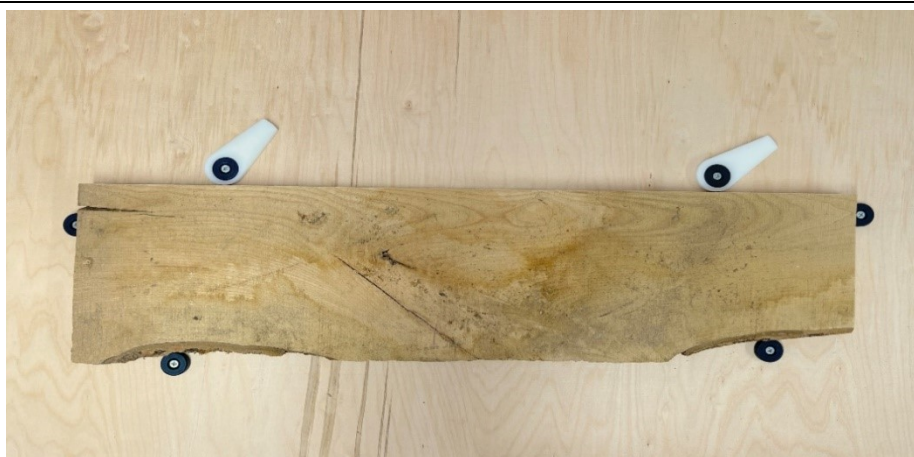
Abbildung 29: Befestigung eines Massivholzbrettes auf der Arbeitsplatte (beispielhaft)
