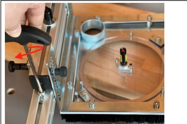
Abbildung 53: Endanschlag der Querschiene gesetzt
