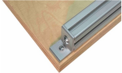
Abbildung 15: Befestigung der rechten Längsschiene auf der Arbeitsplatte
