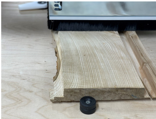
Abbildung 36: Besäumen / Formatieren der Längskanten
