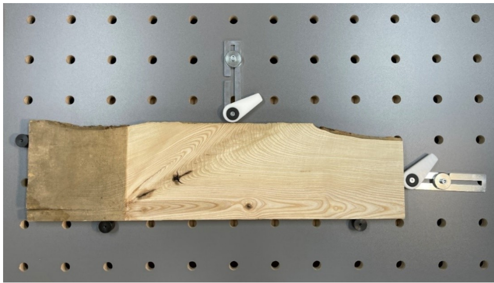
Abbildung 30: Befestigung eines Massivholzbrettes auf der Lochrasterplatte
