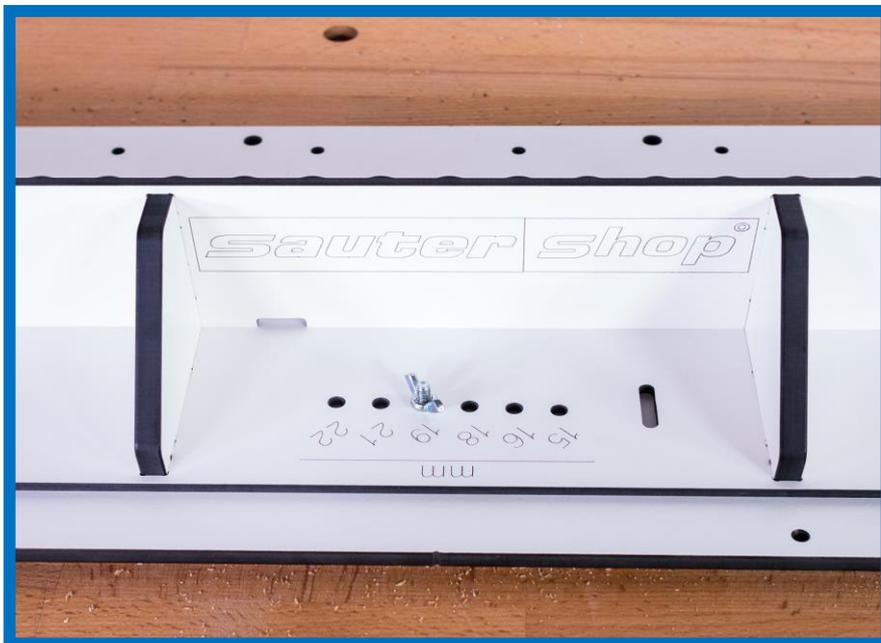
Die Befestigung erfolgt mittels dreier Sechskantschrauben M6 und Flügelmuttern.
