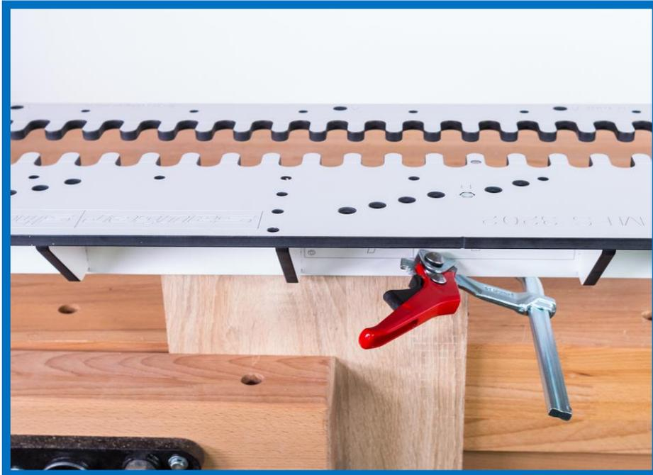
Das Befestigen der Schablone am Werkstück erfolgt mittels zweier Schraubzwingen von unten.
