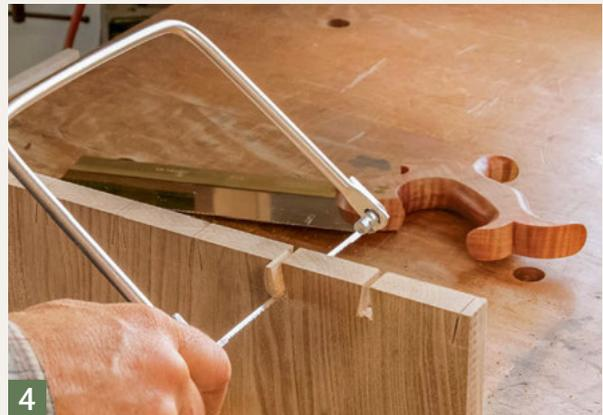
Man kann Schwalbenschwänze zwar auch an der Bandsäge und sogar an der Tischkreissäge anschneiden, aber traditionell ist dies eine Arbeit für Handwerkzeuge. Auch wenn Sie später mit Maschinen arbeiten sollten, denke ich, dass Sie davon profitieren, wenn Sie zuerst das Verfahren mit Handwerkzeug versuchen.
