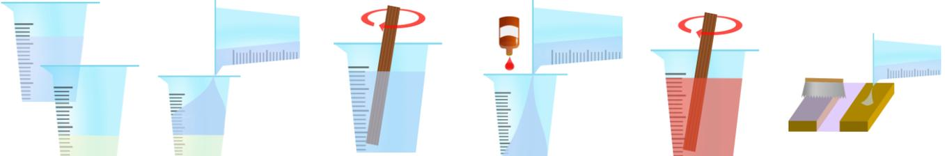
Bei Teilmischungen: Harz und Härter genau in separate Behälter einwiegen.
